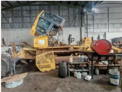
Figura 7. Tractor intervenido en el Taller de la UTGVM. Se realiza un overhaul al motor.
