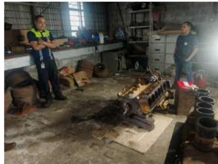
Figura 8. Personal del Taller de la UTGVM realizando un overhaul al motor de un tractor.
