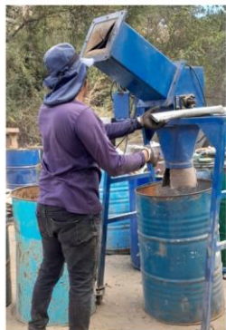
Figura 13. Proceso de quebrado de vidrio mediante quebradora mecánica.
