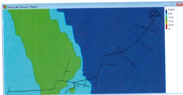
Figura 11. Mapa de presiones en condición de caudal coincidente Hidrante Escuela de Aguas Frías al año 2048, Sistema Aguas Frías
