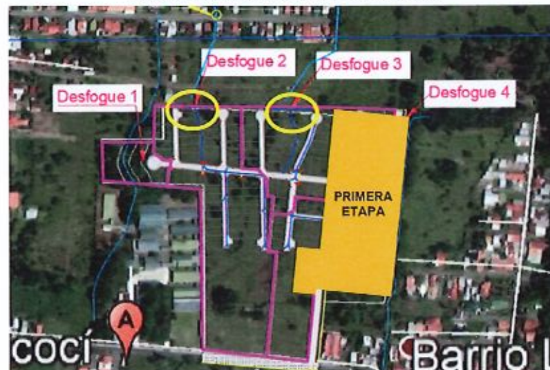
Figura 1.- Puntos de descarga pluvial – Segunda etapa
