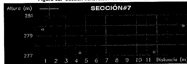
Figura 32.- Sección transversal Río San Rafael ST-7
