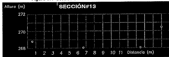
Figura 37.- Sección transversal Río San Rafael ST-13
