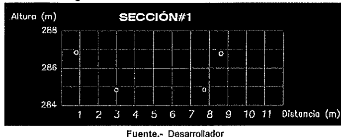
Figura 26.- Sección transversal Rio San Rafael ST-1
