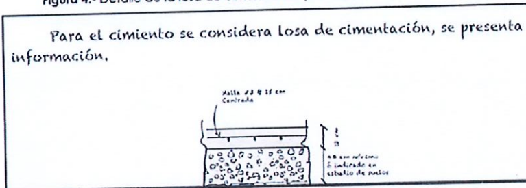
Figura 4.- Detalle de la losa de cimentación (memoria de cálculo estructural)
