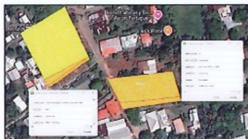
Figura 22. Pantallazo de la capa "zonificacion_condicion.shp" y "condicion_suelo.shp" donde se muestra el área de sobreuso clasificada como zona arbustiva o pasto.
