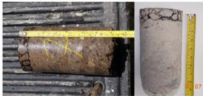
Figura 7.Muestra obtenida mediante perforación en ruta C6-01-037, Cuesta La S (N7)
