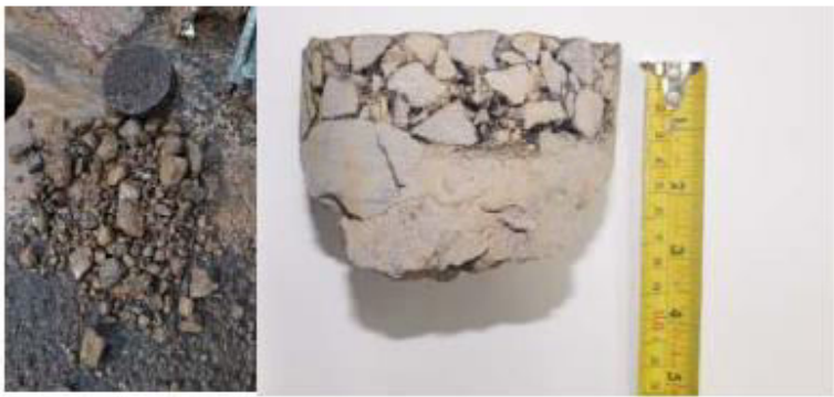
Figura 21. Muestra obtenida mediante perforación en ruta C6-01-136, Santiago
