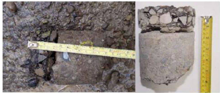
Figura 6.Muestra obtenida mediante perforación en ruta C6-01-037, Cuesta La S (N6)
