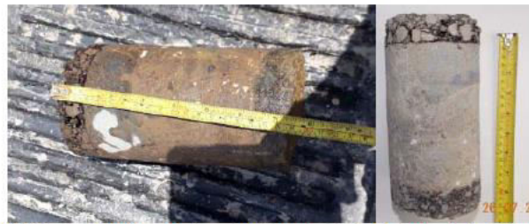
Figura 11. Muestra obtenida mediante perforación en ruta C6-01-164, Cuadrantes Los Mangos (N1)
