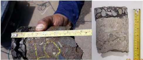
Figura 15. Muestra obtenida mediante perforación en ruta C6-01-037 San Isidro ("Carmen León") (N5)
