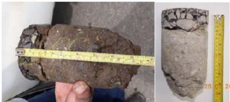
Figura 17. Muestra obtenida mediante perforación en ruta C6-01-148, Cuesta San Martín
