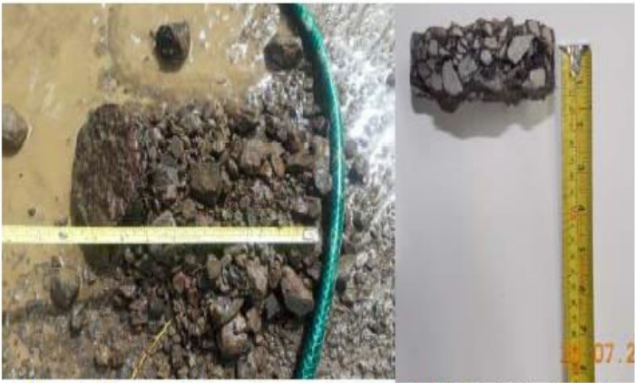
Figura 19. Muestra obtenida mediante perforación en ruta C6-01-152, Bello Horizonte
