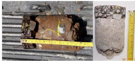
Figura 12. Muestra obtenida mediante perforación en ruta C6-01-164, Cuadrantes Los Mangos (N2)
