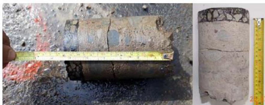
Figura 9. Muestra obtenida mediante perforación en ruta C6-01-152, La Polvosa
